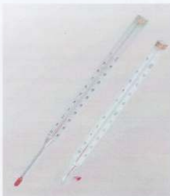
Рисунок 1 - Общий вид термометров стеклянных керосиновых СП-2
